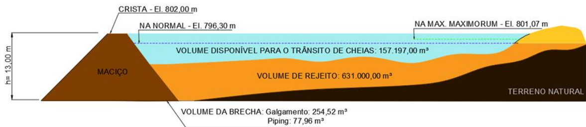
Figura 10.11 - Croqui esquemático do reservatório da Barragem A, no evento de ruptura hipotética.
